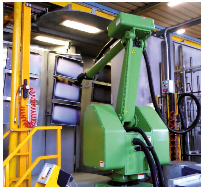
Le bien connu fabricant de robots anthropomorphes CMA Robotics (Pavia di Udine) fournit depuis longtemps des robots anthropomorphes pour l'application directe des peintures en poudre dans des cabines d'application simplifiées (figg. 1 et 2). Développés depuis la fin du siècle dernier pour l'application de produits liquides, les robots anthropomorphes sont entrés lentement dans le secteur d'application de la peinture en poudre, et généralement pour les phases de pré (ou post) retouche.
