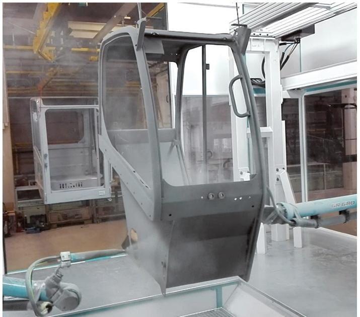
la migliore efficienza di trasferimento, di evitare sovrapplicazioni o scarsi da ritoccare manualmente, generando quantità minime di overspray che si possono considerare a perdere, in quanto al di sotto delle quantità non recuperabili dai sistemi di riciclo tipici (intorno all'8%).
